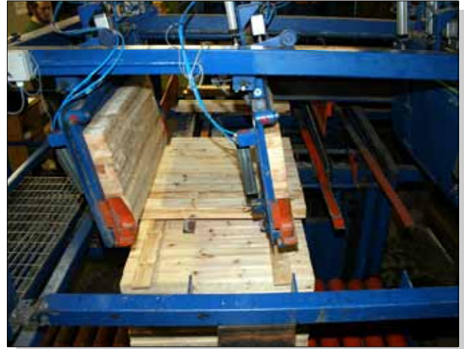
6. Lattenmagazine, welche auch Bretter ablegen können
