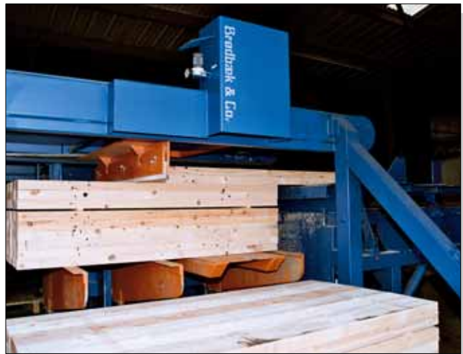
2. Längsweisse Lagenentstapelung, mittels Schiebsystem
