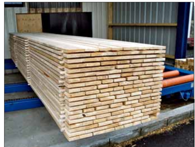
9. Stapelung gemischter Breiten mit Lücken Ausgleich, für bündige Schnittholzpakete
