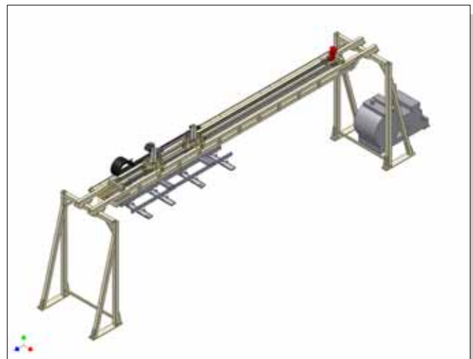
4. Längsweisse Lagenentstapelung, mittels Vakuumheber
