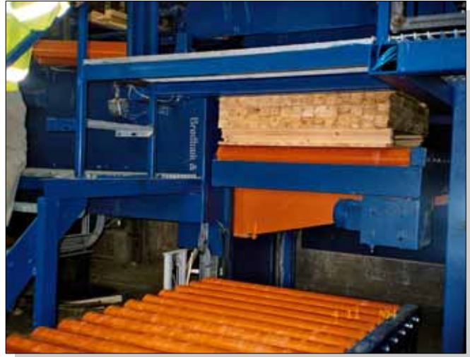
19. Für den Transport mit dem Gabelstapler werden Bretter gleicher Abmessungen wie im Paket mehrlagig unterlegt und eingebunden.
