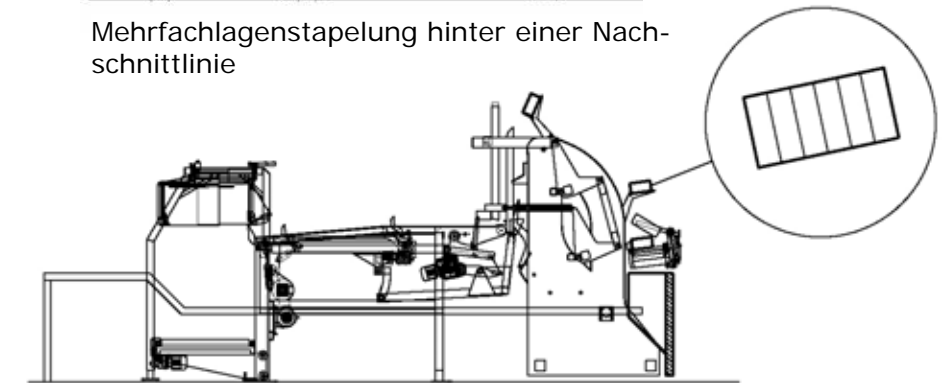
Hochleistungsstapelanlage, Kapazität bis zu 500 Bretter/min.
