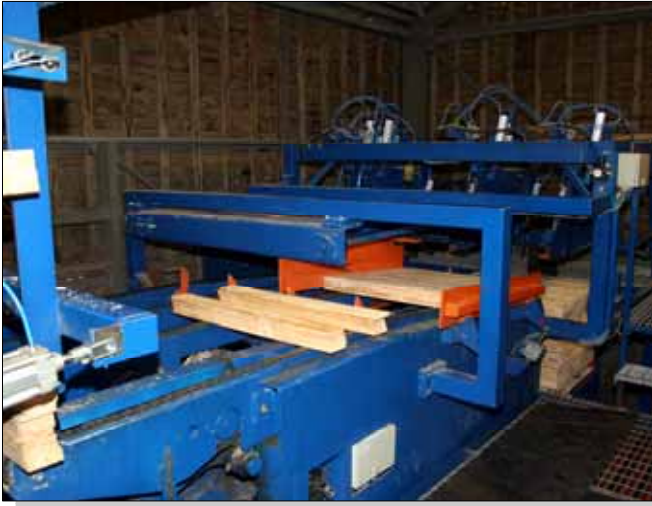
16. Beidseitig bündige Lagenausrichtung vor der Übergabe in den Hochleistungsstapler
