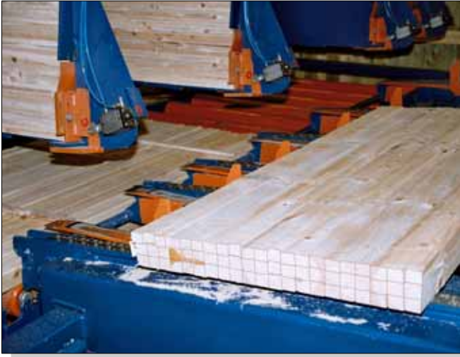
10. Lagenstapelung von Holz - in Rahmen nachgeschnitten
