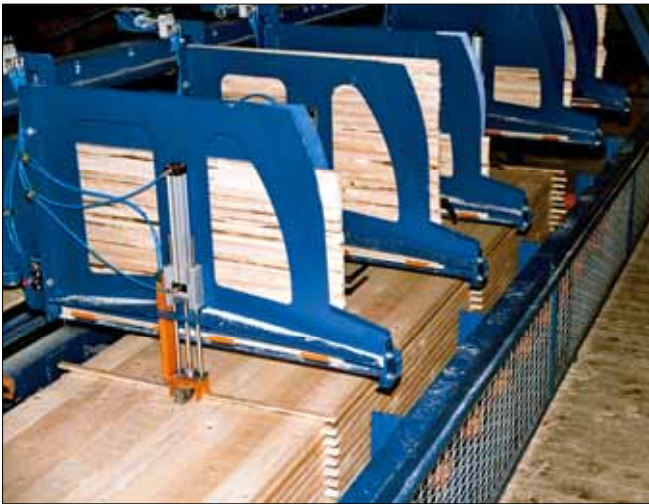
7. Lattenmagazine, handbefüllt, mit pneum. Greifern für schnelle und sehr genaue Lattenablegung
