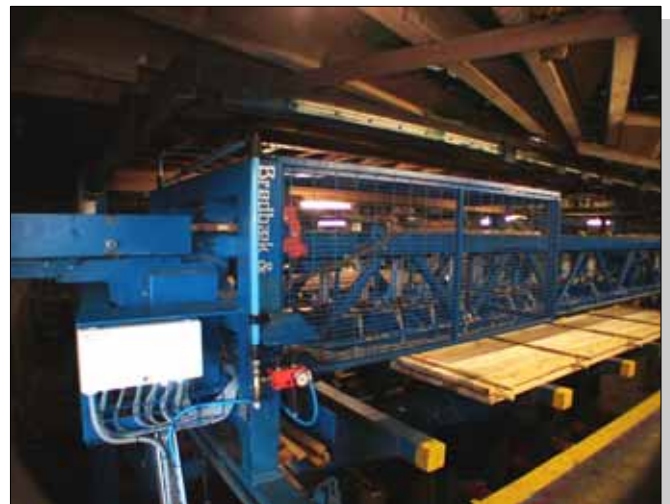
8. BCO Latten Robot kann automatisch bis zu 120 Latten/min. exakt ablegen
