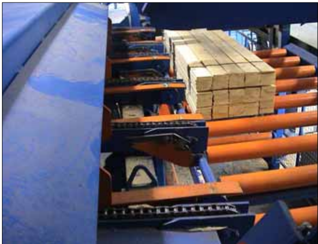
12. Bündelumreifung kann vor der Stapelung stattfinden
